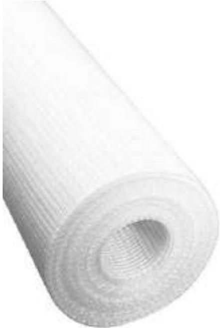
a rete di armatura in fibra di vetro, con appretto antialcalino, peso 160 g/m<sup>2</sup>, componente fondamentale dello strato di rasatura armata, a la funzione di conferire una adeguata capacità di resistere alle tensioni derivanti dagli sbalzi termici e da fenomeni di ritiro sviluppati dai pannelli isolanti. Contribuisce al miglioramento delle resistenze meccaniche del sistema.
