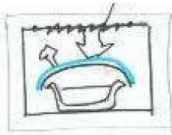
**Isolante sottile termoriflettente = sistema di isolamento termico composto da una o più superfici riflettenti confinanti con una o più intercapedini di aria.**
